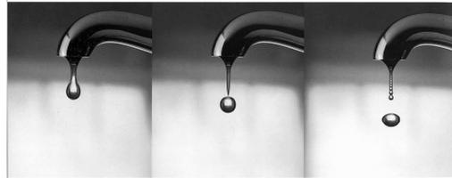
FIGURE 3.24 – Détachement d'une goutte pendante ([23], p. 8).
