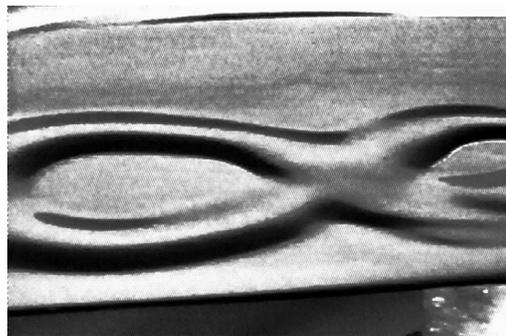
FIGURE 3.26 – Effet d'un point froid se déplaçant sous une couche mince de liquide.
