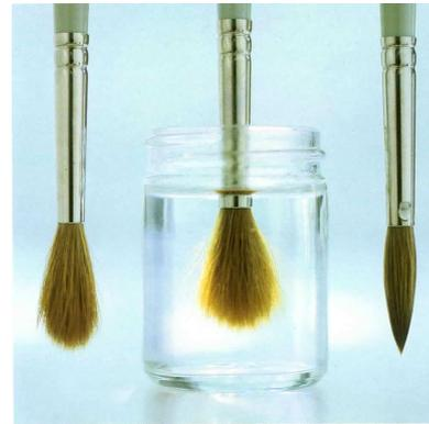
FIGURE 3.2 – Effet des forces capillaires sur un pinceau sec, immergé ou mouillé. (D'après [23], p. 12).
