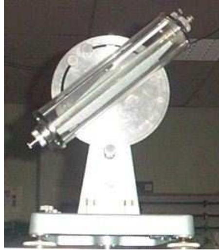
FIGURE 1.6 – Viscosimètre à chute de bille.
