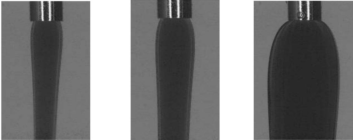
FIGURE 1.27 – Ecoulement d'un fluide visco-élastique à la sortie d'un tube cylindrique. Les photos montrent le gonflement progressif du jet à la sortie d'un tube lorsque le taux de cisaillement augmente (de gauche à droite :  $\dot{\epsilon} = 24$  puis 60 puis 240  $s^{-1}$ ). Ce gonflement met en évidence l'existence de contraintes normales dans ce fluide. (Photos L. Pauchard, FAST Orsay.)
