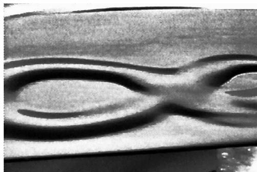
FIGURE 6.26 – Effet d'un point froid se déplaçant sous une couche mince de liquide.
