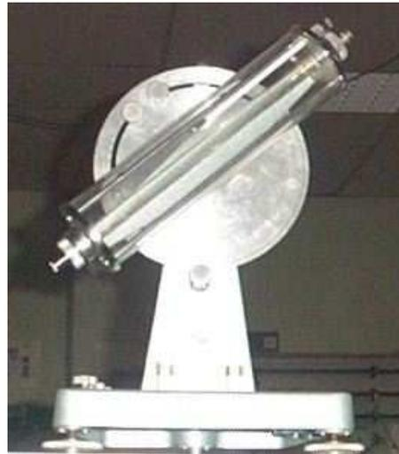
FIGURE 9.4 – Viscosimètre à chute de bille.
