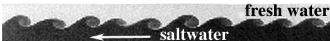
FIGURE 16.7 – Photographie de l'expérience de Thorpe entre deux fluides miscibles superposés mis en mouvement par l'inclinaison temporaire de la cellule.
