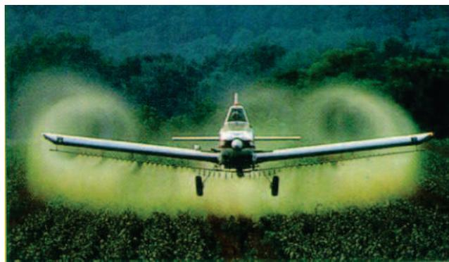
FIGURE 13.8 – Visualisation des vortex de bout d'aile.
