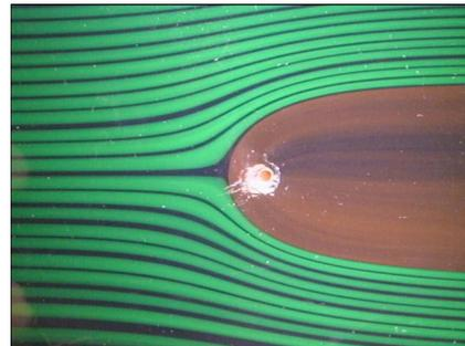
FIGURE 14.4 – Lignes de courant autour d'un solide de Rankine (écoulement uniforme plus une source ponctuelle de fluide) visualisées dans une cellule de Hele-Shaw.
