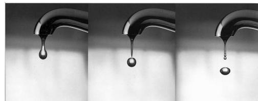
FIGURE 6.24 – Détachement d'une goutte pendante ([53], p. 8).
