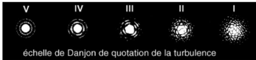
FIGURE 1.14 – Effet de la turbulence atmosphérique sur la PSF. L'échelle de Danjon qualifie le degré de turbulence, du plus faible (V) au plus élevé (I). [Source : https://shorturl.at/aovS3 ]
