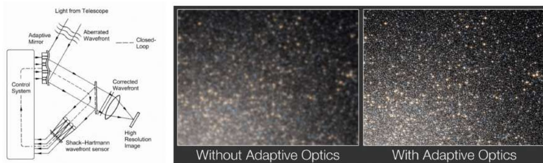
FIGURE 1.15 – Optique adaptative. Schéma de principe de la déformation du miroir (à gauche, Source : https://shorturl.at/filxZ ) et comparaison avec et sans optique adaptative sur l'observation d'un amas globulaire (à droite, Crédit : ESO).
