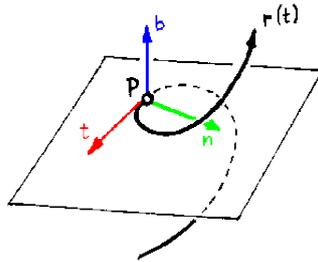
FIGURE 2 – Schéma d'une corde avec le repère de Frenet  $(\mathbf{t}, \mathbf{n}, \mathbf{b})$ .
