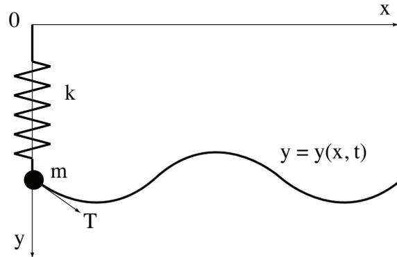
FIGURE 1 – Oscillateur harmonique couplé à une corde vibrante.
